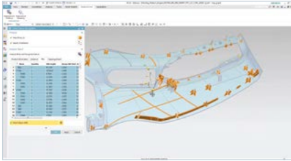
Automatisches Erkennen von Formelementen auf Guss- oder Stanzteilen, einschließlich Hinterschnitten, Rippen und Biegungen, mit NX Feature2Cost
